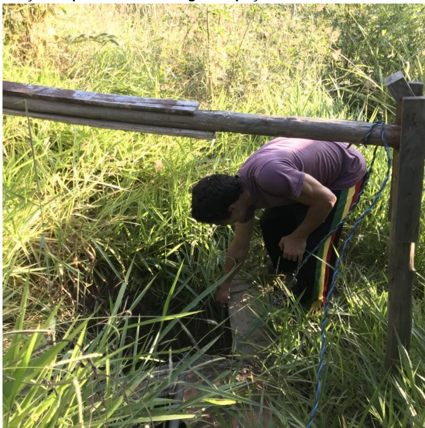
Figura 20 - Medição da profundidade da água no poço 1 com auxílio de uma vara de bambu.
