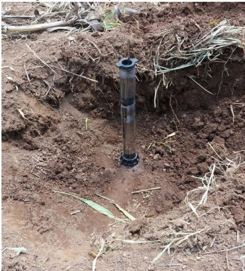
Figura 27 - Ensaio de permeabilidade do solo in-situ
